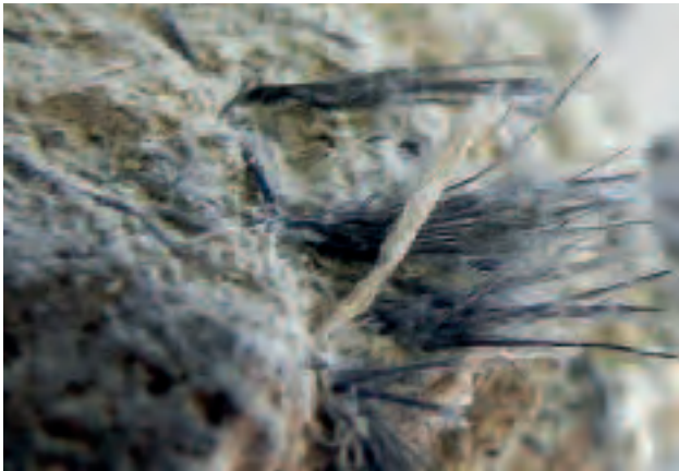
3. Dettaglio di un pannello di Eternit con la tipica coesistenza di fibre bianche (crisotilo) e blu (crocidolite) (foto G. Pagani)
